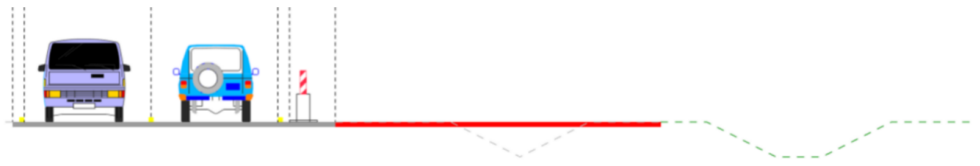
Figur 140 Anlægsfase 2, Indsnævring af kørebane – Broarbejder, afvanding og ny vejkasse
