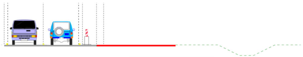
Figur 141 Anlægsfase 3, Yderligere indsnævring af kørebane – Asfaltarbejder
