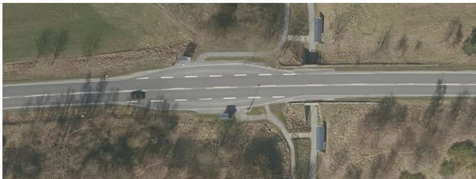
Figur 37 Principiel udformning af buslommer. Kilde: vejregel: Sideanlæg i åbent land.
