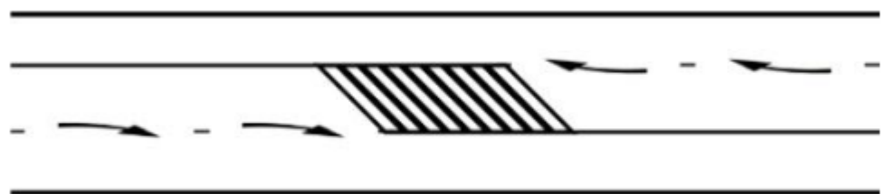
Figur 36 Overgangsstrækning, principskitse. Kilde: vejregel: Fælles grundlag og planlægning for vejkryds i åbent land.
