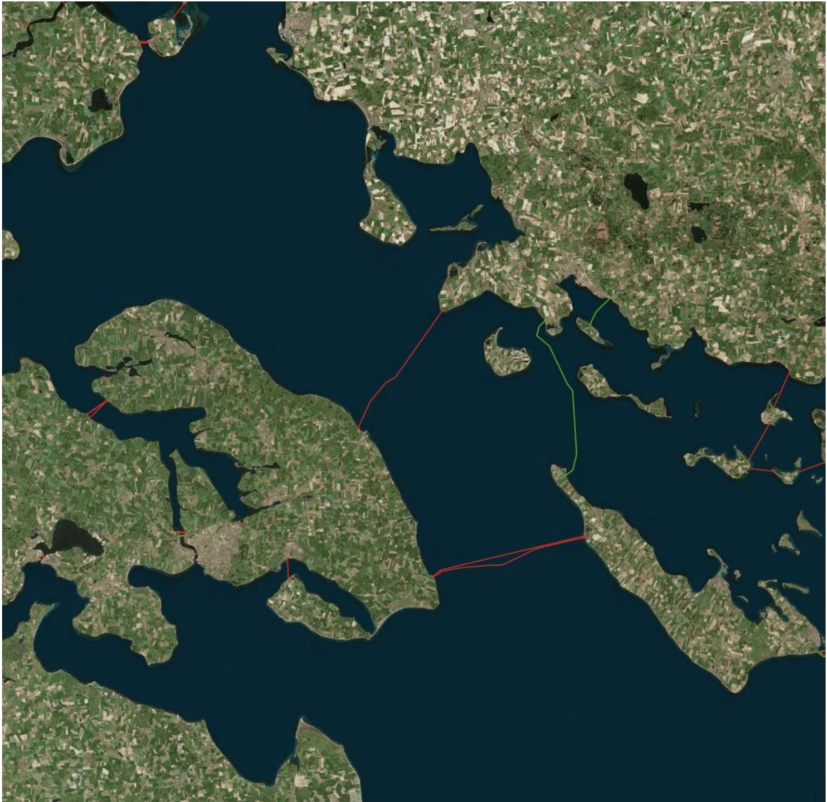
Figur 2-9 - Ledninger offshore (grøn: kommunikation, rød: power) ref. [8].
