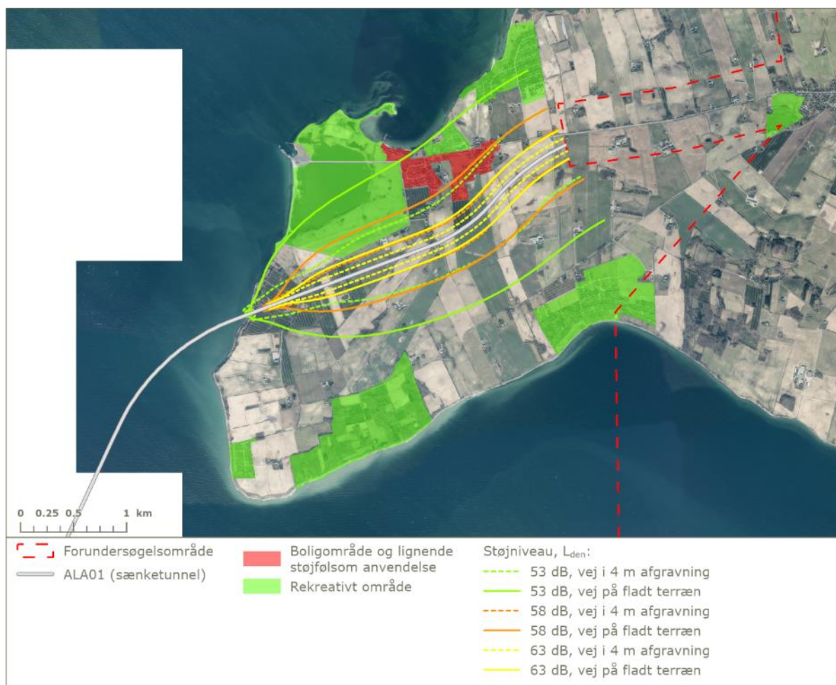
Figur 4-2. Støjkonsekvenszonerne for vejstøj fra ALA01 på Fyn samt centerlinjen for korridoren. Illustreret er tunnellsningen hvor det er muligt at se betydningen af støjbredelsen i forholdt til tunnelmundingen.
