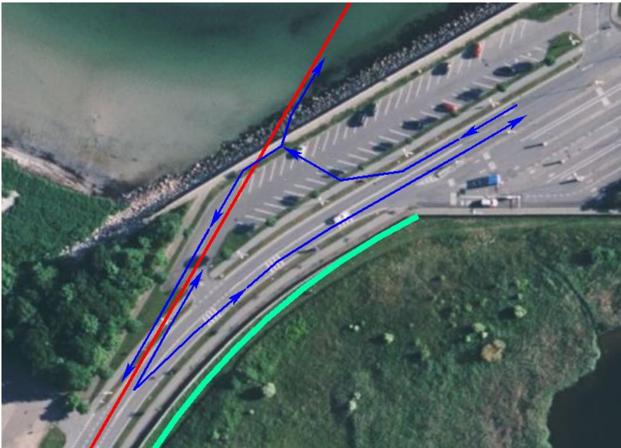
Figur 7-8. Forslag til udformning af adgang til Fynshav havn. Den røde linje indikerer linjeføringen for kyst-kyst forbindelsen. De blå pile indikerer trafikretningen for den kørende trafik. De grønne linjer indikerer tilslutningen for cyklister og fodgængere.
