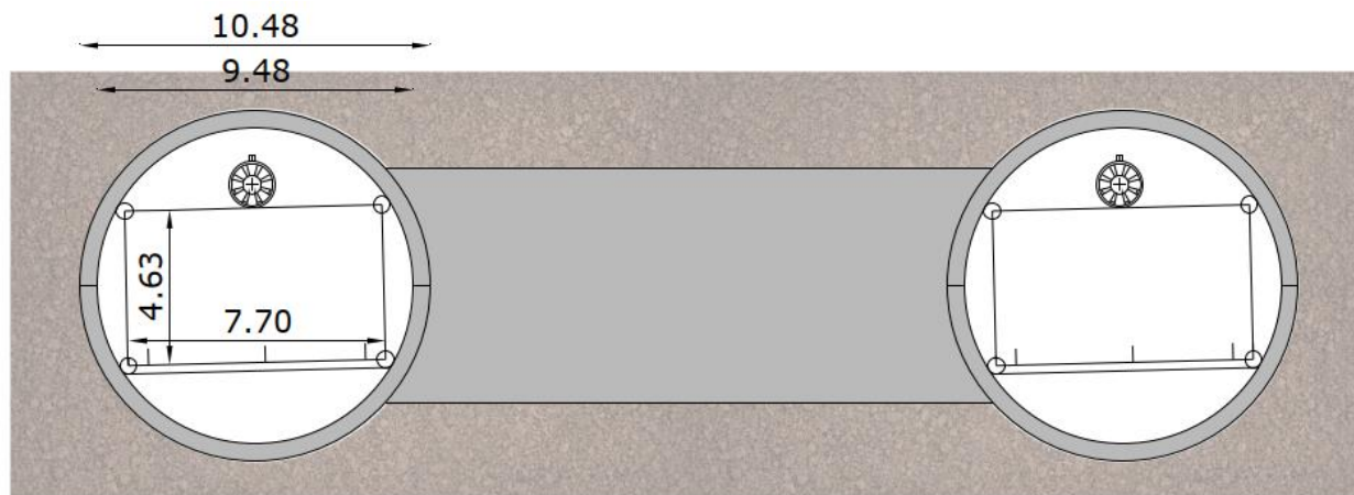
Figur 6-10 Skitse af basisløsningen for den borede tunnel ved en tværtunnel.
