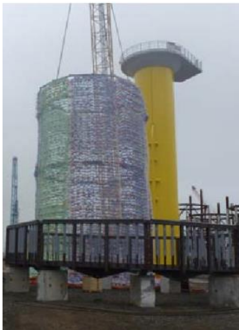
Figur 7-55 Foto visende konceptet " hydro sound damper.
