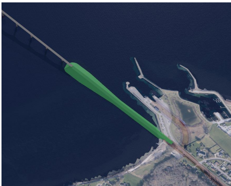
Figur 9-18 Illustration af permanent dæmning ved Fynshav. Dæmningen har en udstrækning på ca. 600 m.
