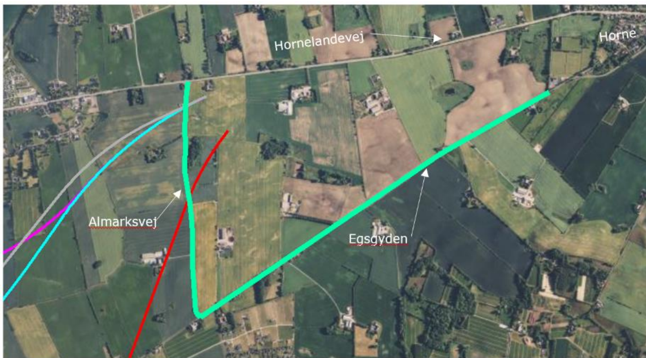
Figur 7-12. Illustration af tilslutning af cyklister på Fyn-siden. De farvede linjer, som er vist til højre på figuren, indikerer linjeføringer svarende til de undersøgte korridorer. De grønne linjer indikerer tilslutningen for cyklister og fodgængere.
