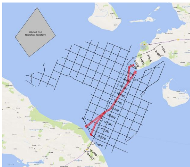
Figur 2-1 Illustration af undersøgelsesområde, dvs. sejl-/undersøgelseslinjer for GEUS' indledende geofysiske undersøgelse udført i 2023. Afstanden mellem sejl/undersøgelseslinjer er ca. 1 km. Undersøgelseskorridorerne for Energinets undersøgelse for kabelrute mellem Fyn og Als vist med rødt. Undersøgelsesområdet for vindmølleparken Lillebælt Syd indikeret nord for Als Fyn undersøgelsesområdet.
