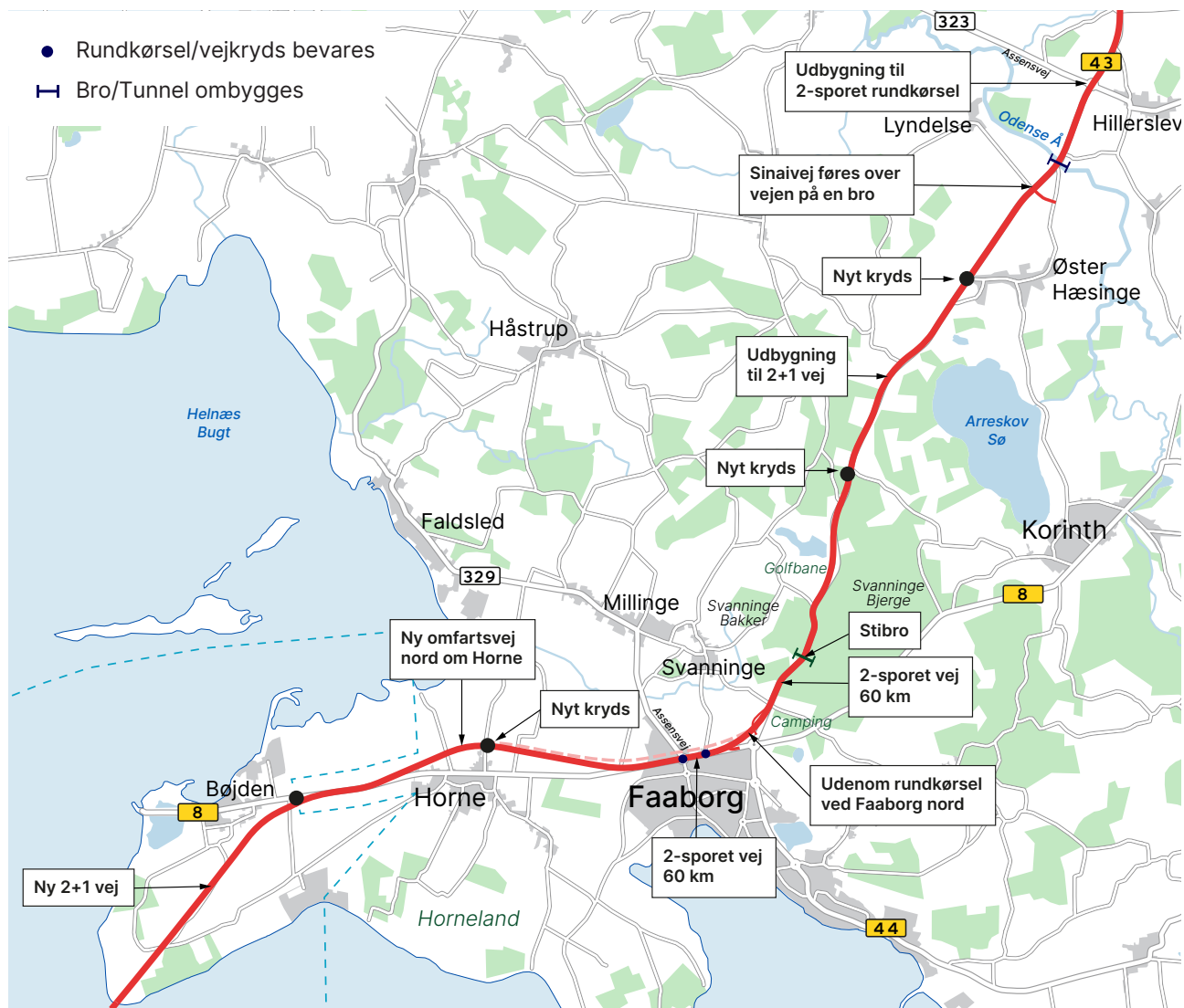
Figur 4.9 Udbygning på den sydlige vejstrækning på Fyn
