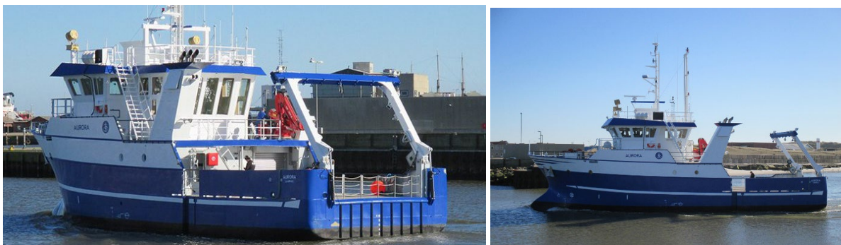
Figur 2. Surveyskibet Aurora med en agter A-ramme, hvorfra det seismiske udstyr blev betjent. (fotos: Aurora).
