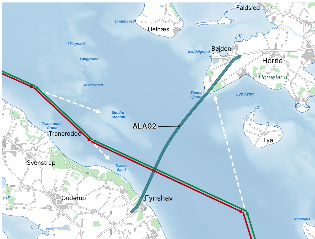
Figur 3.14 Anbefalede sejlruer, som markeres med bøjer for hhv. sydgående (rød) og nordgående (grøn) trafik. Hvidstiplet er en illustration af at trafikken ikke vil lede til påsejling af broen i tilfælde af at skibene ikke ændrer rute ved ruteknæk, fordi de enten vil støde på grund ved Søndre Stenrøn, Taksensand eller Horneland.
