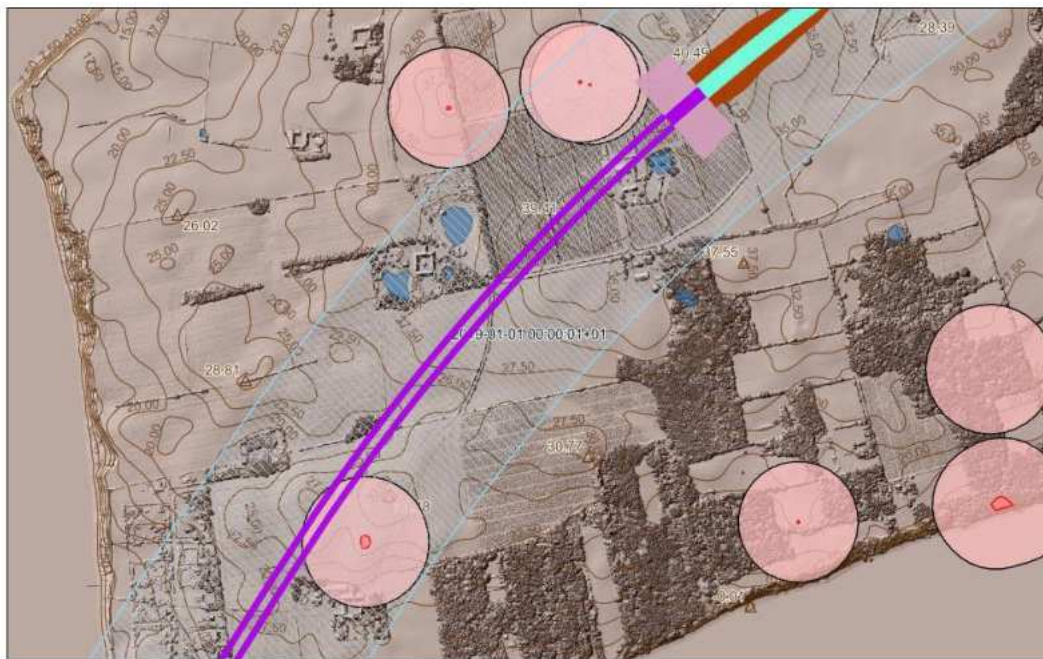
Figur 20-31 Kortet viser hvordan anlægget berører 100 m beskyttelseslinjerne (lyserøde cirkler) omkring to fortidsminder omkring området hvor tunnelen føres i terræn og én fortidsmindebeskyttelseslinje i linjeføringens tracé, hvor vejen underbores.
