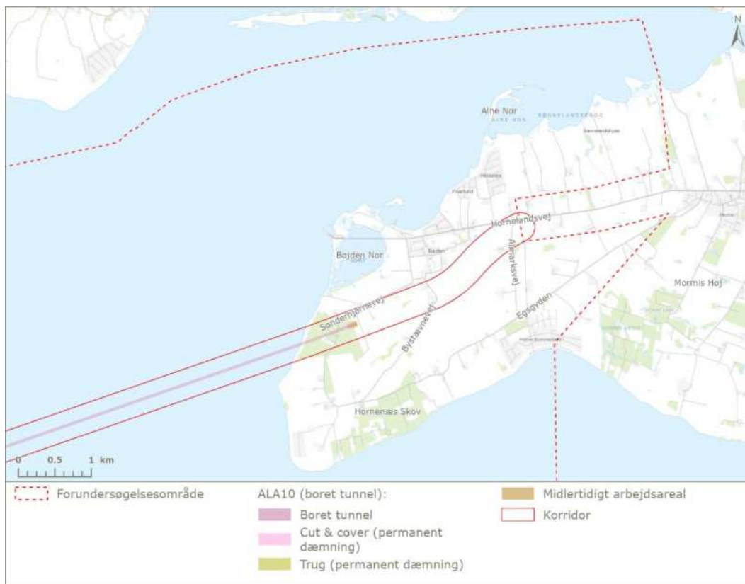
Figur 19-5 Skitsetegning ALA10 Boret tunnel på Fyn og korridoren frem til grænsefladen med landanlæg.
