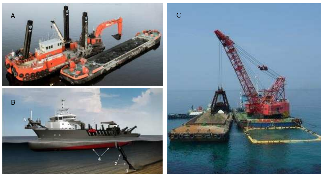
Figur 5-15 A: Backhoe dredger, B: Trailing suction hopper dredger og C: Clamshell dredger.
