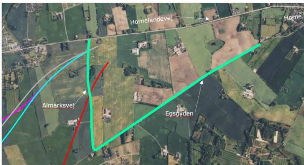
Figur 5-3 Illustration af tilslutning af cyklister på Fyn-siden. De farvede linjer, som er vist til højre på figuren, indikerer linjeføringer svarende til de undersøgte korridorer. De grønne linjer indikerer tilslutningen for cyklister og fodgængere.
