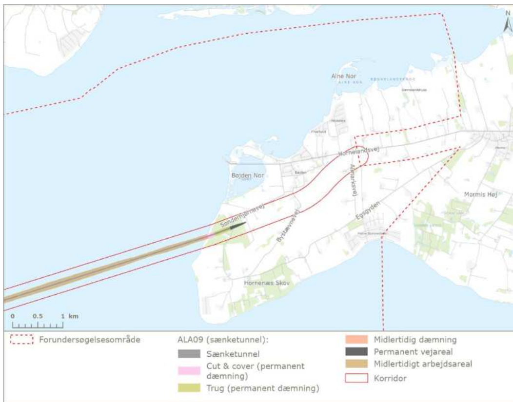
Figur 18-6 Skitsetegning af ALA09 Sænketunnel ved ilandføringen på Fyn.
