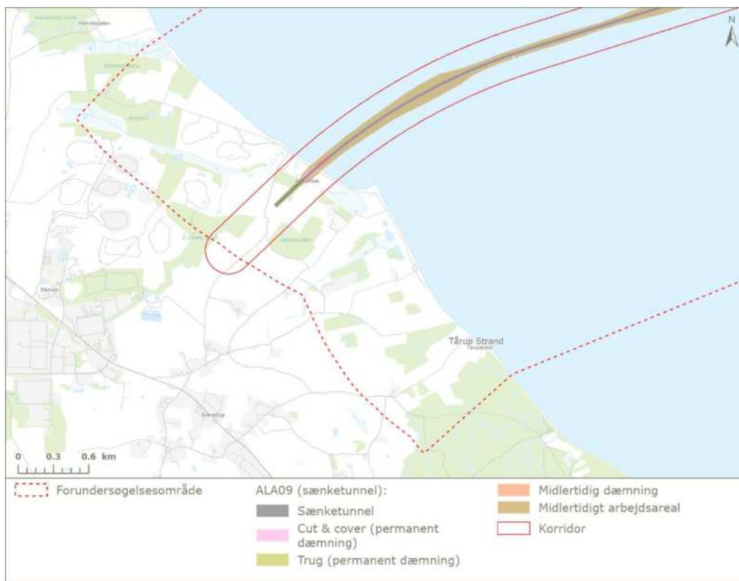
Figur 18-2 Skitsetegning anlægget ved ilandføringen på Als.
