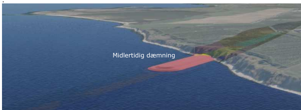
Figur 18-5 Visualisering af ALA09 Sænketunnel – set fra Fyn. Ved Fyn anlægges en midlertidig arbejdsdæmning i forbindelse med anlæg af det første tunnelelement.
